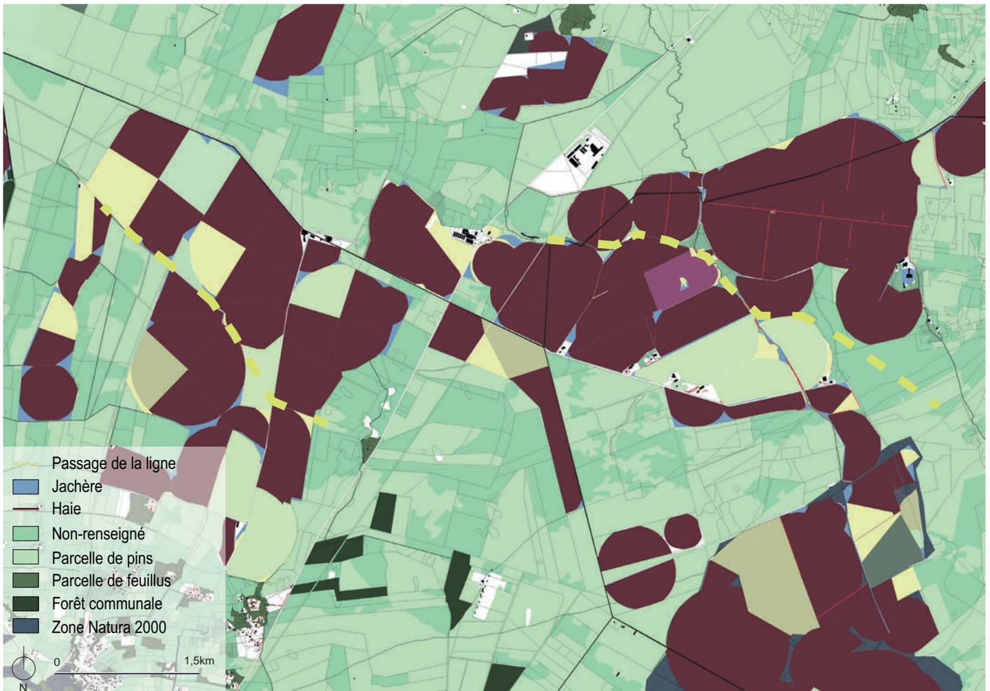
Les zones laissées en bord des parcelles circulaires permettent de créer des passages pour la ligne électrique. (Carte réalisée à partir des données de l'IGN.)
