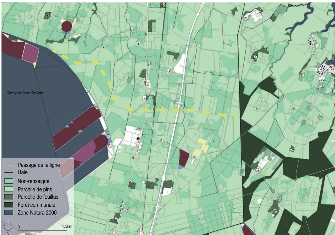
Placer la ligne le plus loin possible des habitations pour limiter les vues sur les pylônes. (Carte réalisée à partir des données de l'IGN.)
