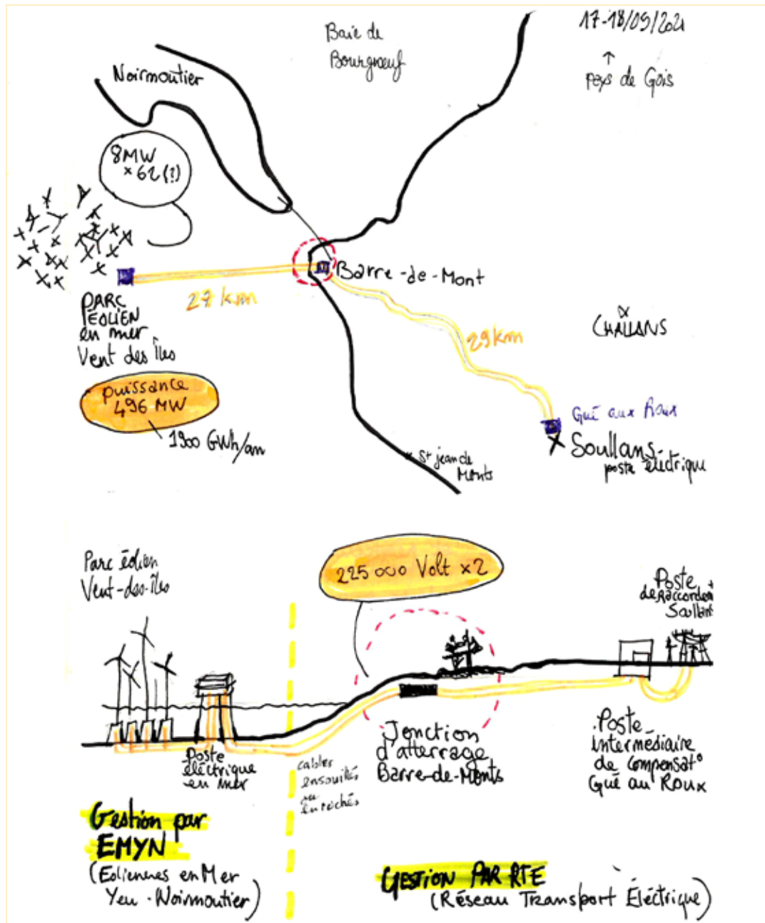
Coupe de principe du réseau (source: RTE)
