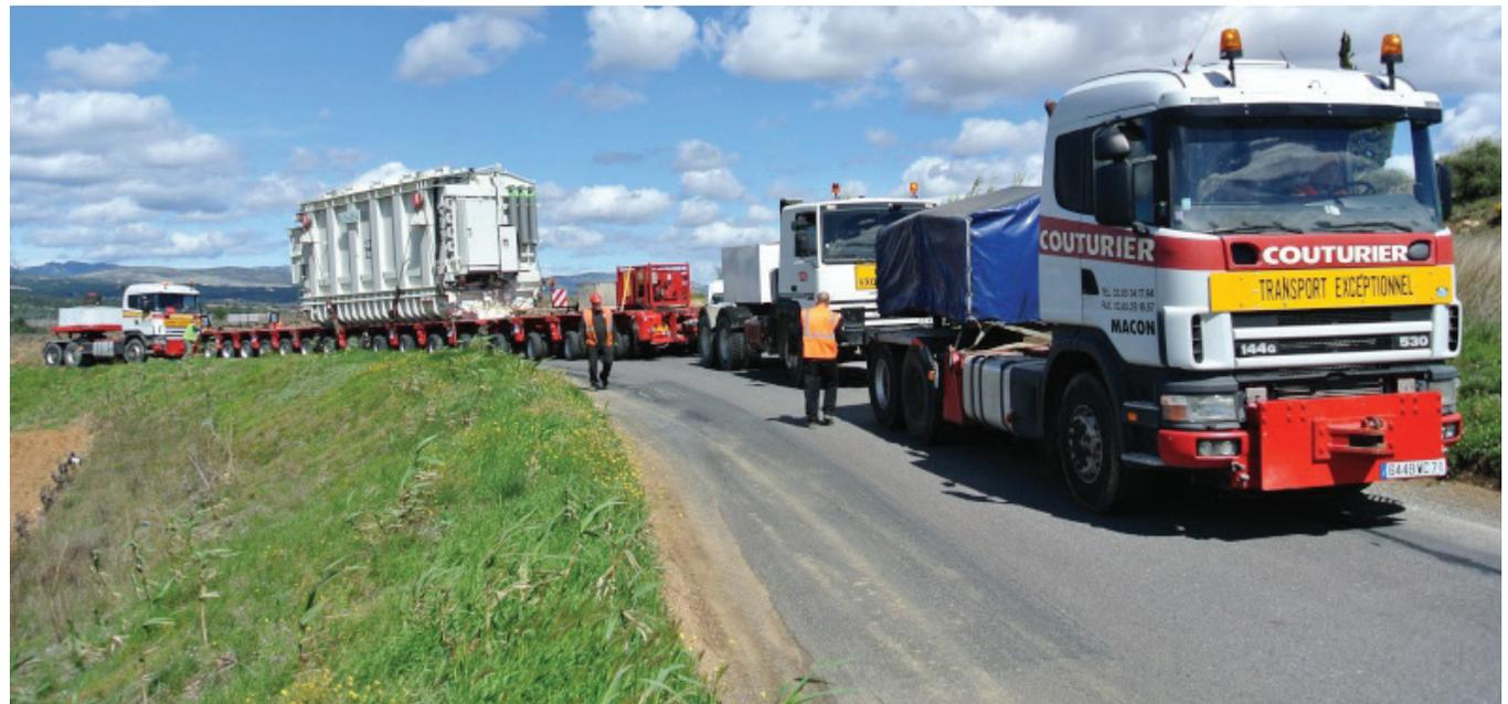
Photo du convoi exceptionnel d'un transformateur, liaison à la station de conversion de Baixas (66)
